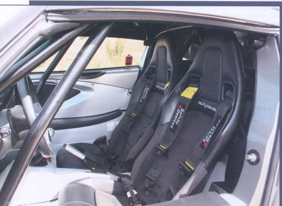
S'il ne facilite pas l'accès à bord, l'arceau de sécurité augmente la rigidité du châssis. Bien serrés, les harnais 4 points permettent au conducteur de faire complètement corps avec sa machine.
