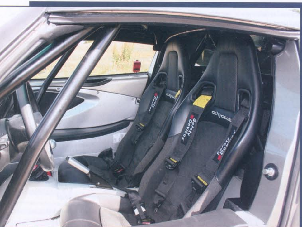
De veiligheidskooi is geen plezier bij het instappen, maar draagt wel aanzienlijk bij tot een nog grotere koetswerkstijfheid. Het vierpuntsharnas houdt de bestuurder-coureur stevig op zijn plaats.
