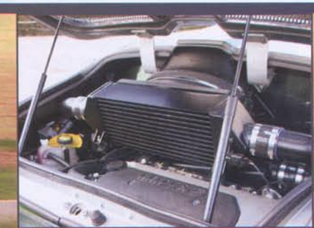
De 1.8-motor van Toyota-origine werd in dit geval voorzien van een Roots-compressor.
